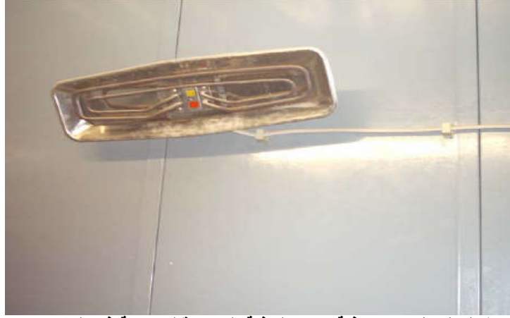
شكل (٢٨) جهاز تدفئة خاص لتدفئة البيض قبل وضعة فى المفرخ
