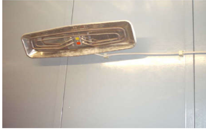
شكل (182) جهاز تدفئة خاص لتدفئة البيض قبل وضعة فى المفرخ
