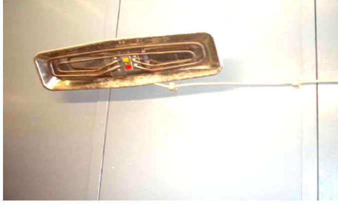
شكل (237) يوضح جهاز تدفئة خاص لتدفئة البيض قبل وضعه في المفرخ
