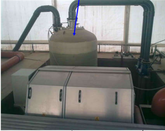
شكل يوضح خزان تنظيم كمية وتركيز الأوكسجين المذاب والمضخة
