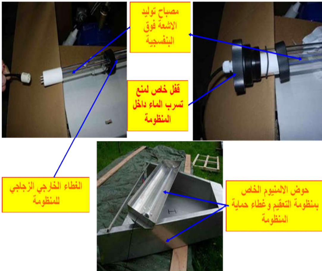
شكل يوضح منظومة تعقيم المياه باستخدام الأشعة فوق البنفسجية
