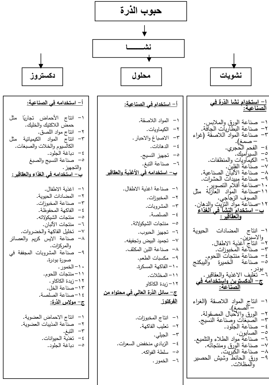
شكل (٧٤) رسم تخطيطي يوضح بعض المكونات التي يمكن الحصول عليها من حبة الذرة
